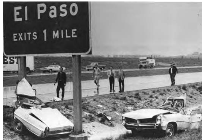
Figure 1. A car sliced in two when hitting a large steel signpost Slika 1. Automobil prepolovljen uslijed udara u veliki čelični stup za prometni znak
